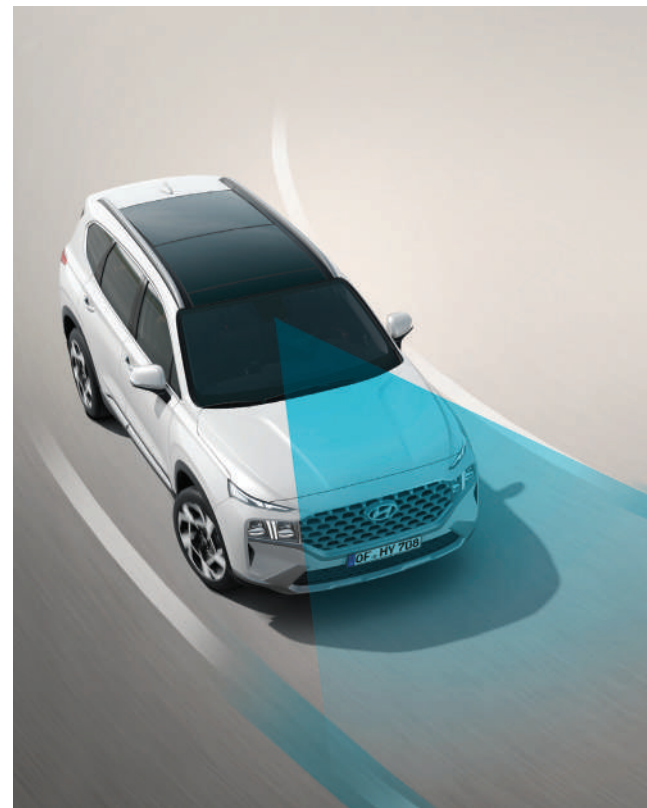
Ассистент движения в полосе (LFA) Удерживает автомобиль на занимаемой полосе движения, повышая уровень безопасности. Когда система LFA включена, она поддерживает автомобиль по центру занимаемой полосы при движении по автомагистралям или городским улицам на скоростях от 0 до 180 км/ч.
