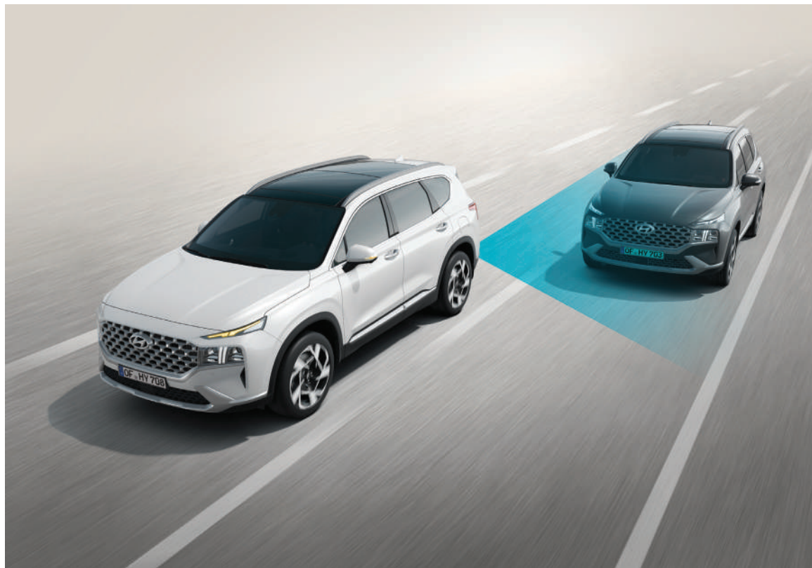
Система предотвращения столкновений в «слепых» зонах (BSA) Система BSA с помощью радарных датчиков в нижней части заднего бампера и фронтальной камеры, обнаруживает транспортные средства в «слепой» зоне и предупреждает об этом водителя, активируя соответствующий индикатор. Если в такой ситуации включить указатель поворота, автомобиль подаст звуковое предупреждение и активирует тормозные механизмы, чтобы избежать столкновения.
