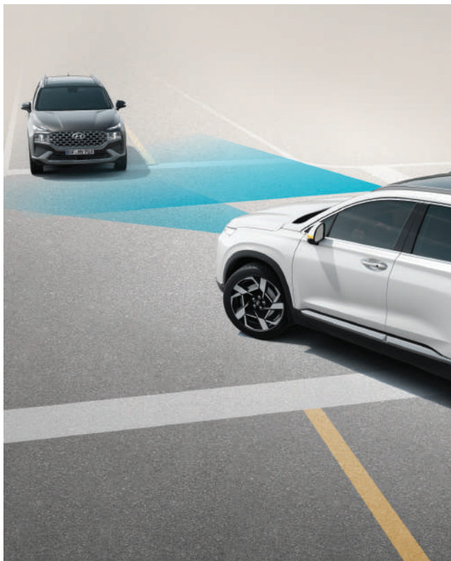
Система предотвращения фронтальных столкновений (FCA с функцией помощи при проезде перекрестка) Система FCA помогает предотвратить столкновение с другими транспортными средствами, пешеходами или велосипедистами. Автоматически снижает скорость, предупреждая водителя о возможных столкновениях при движении. То же самое происходит, если есть риск столкновения при повороте налево на перекрёстке.
