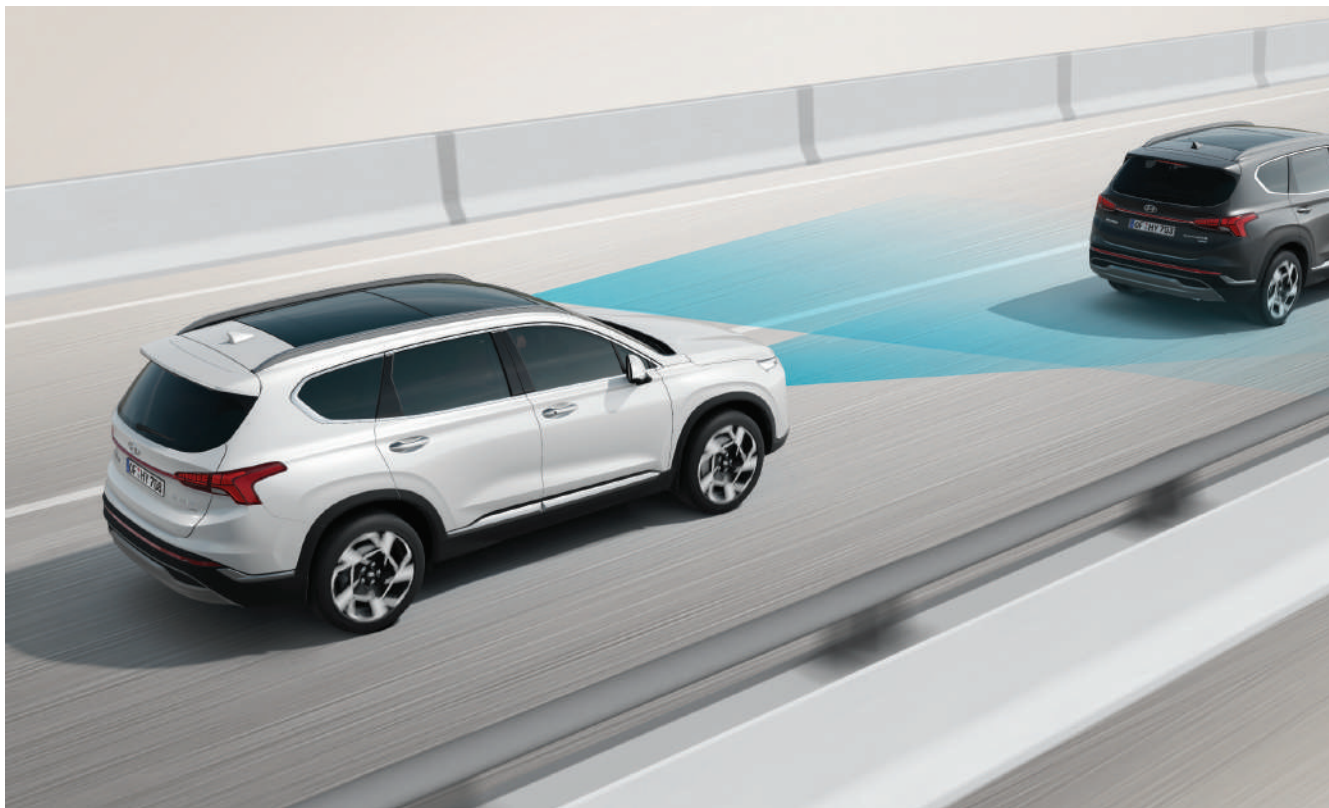
Интеллектуальный круиз-контроль с ассистентом движения в пробке (SCC) Поддерживает заданные скорость и дистанцию до впереди идущего транспортного средства. При кратковременной остановке возобновит движение автоматически.
